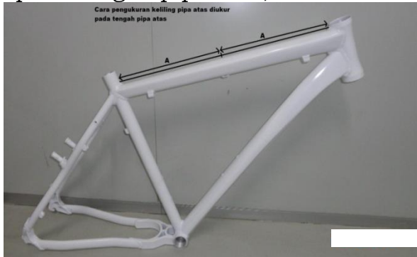
Gambar 4. Cara Pengukuran Keliling Pipa Atas
