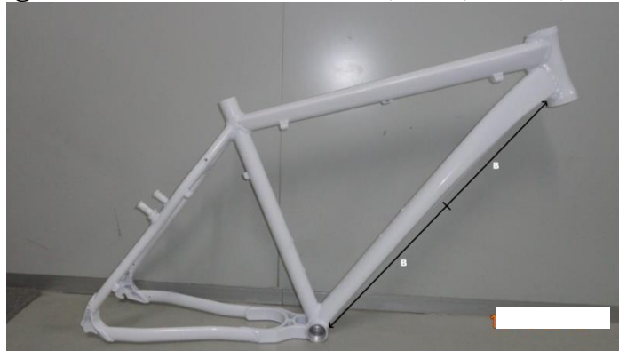
Gambar 5. Cara Penentuan Pipa Bawah
