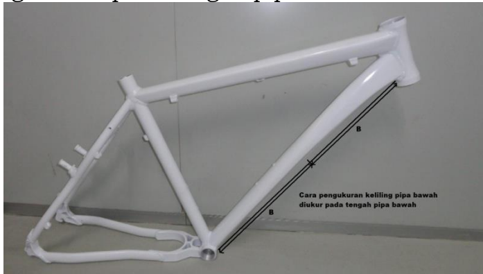
Gambar 6. Cara pengukuran pipa bawah.
