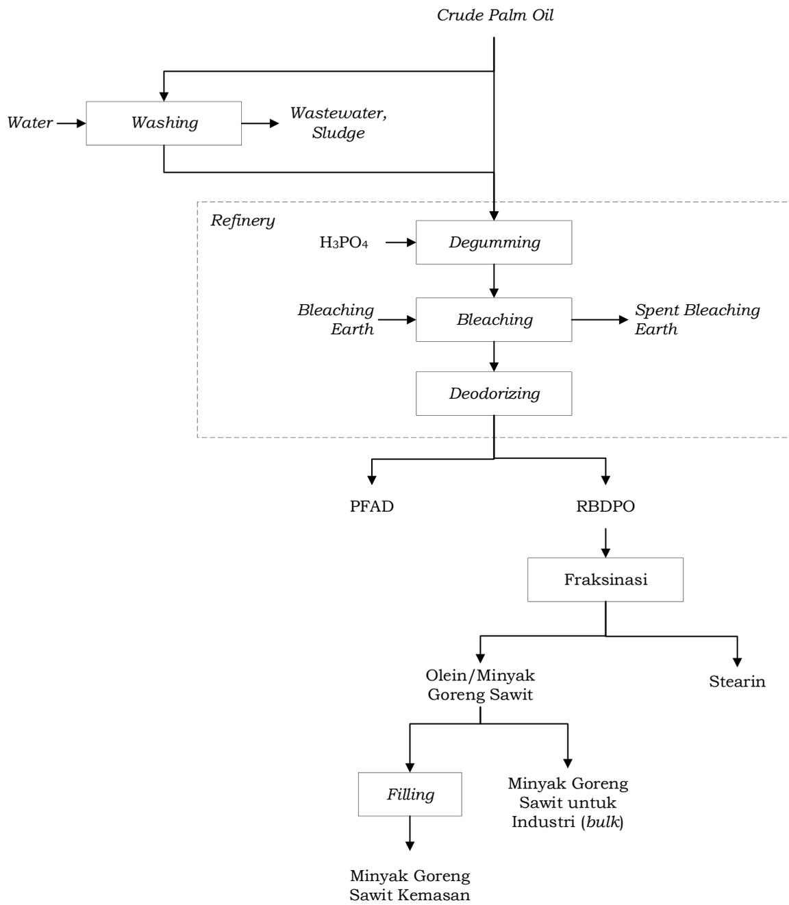
Gambar 2. Bagan Alir Produksi Minyak Goreng Kelapa Sawit
