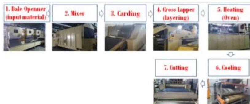
Gambar 3 – Bagan Alir Proses Produksi Industri Suku Cadang dan Aksesori Kendaraan Bermotor Roda Empat atau Lebih-Felt sebagai Material Silencer
