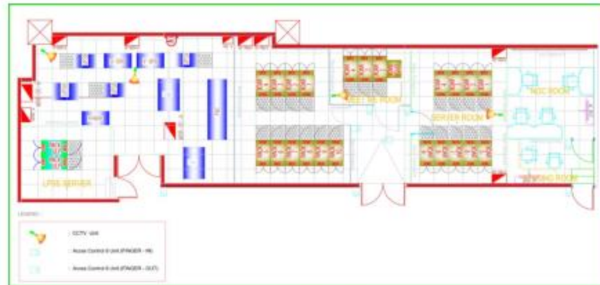
Gambar 6. Cctv dan ad dc
