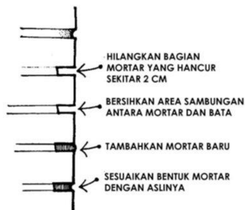
Gambar E.2.1. Cara melakukan Repointing
