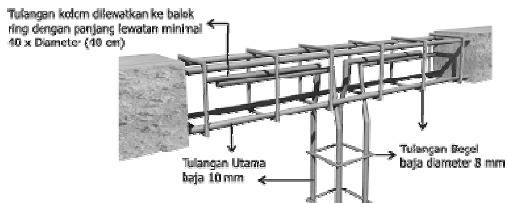
Gambar 48. Hubungan Anatar Kolom dengan Balok Keliling/ Ring
