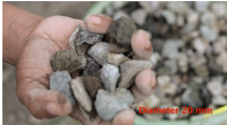
Gambar 5. Diameter Kerikil Yang Baik Untuk Campuran Beton
