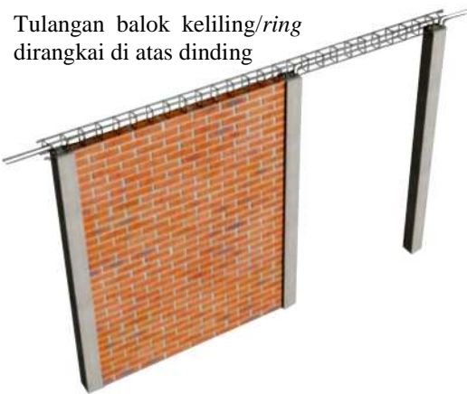
Gambar 59. Perangkaian Tulangan Balok Keliling/ Ring Di Atas Dinding
