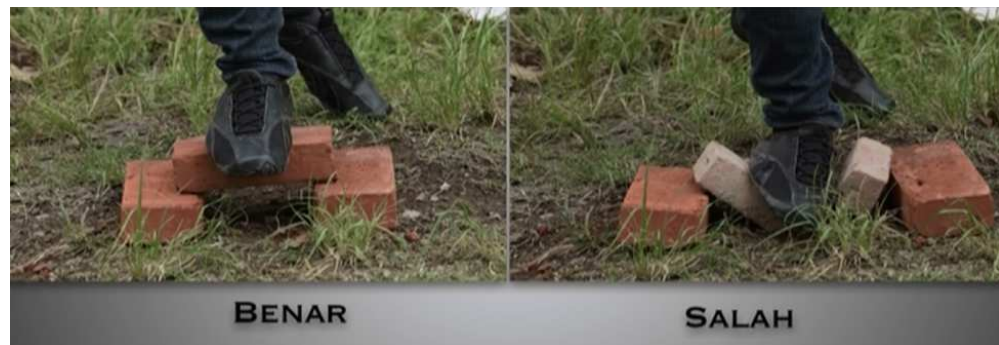
Gambar 13. Pengujian Sederhana Kekuatan Batu Bata
