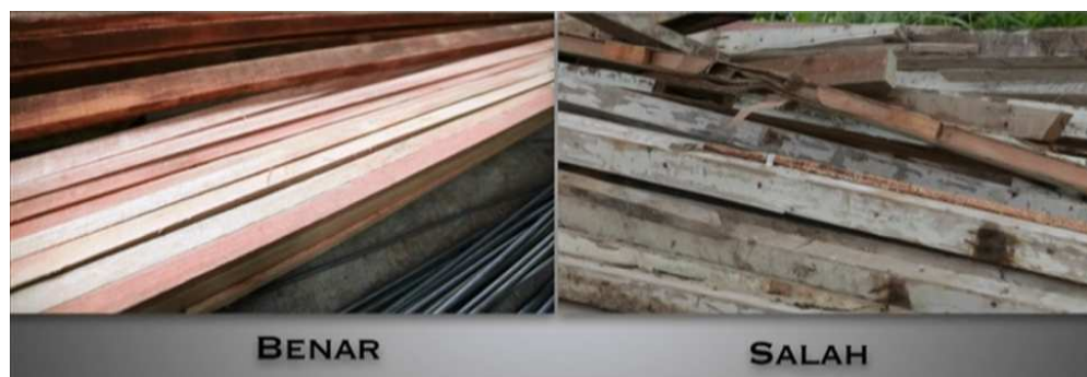
Gambar 16. Kayu Yang Baik Digunakan Dalam Pembangunan
