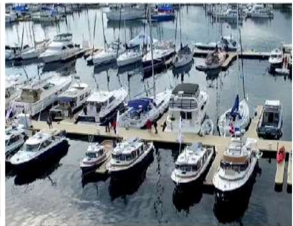
Gambar. Contoh Penerapan Titik Labuh/ Singgah Kapal Yacht yang mengkombinasikan Single Berth Configuration (kiri) dan Double Berth Configuration (kanan) (Lokasi: Nanaimo Yacht Club Dock, Kanada, Sumber:
