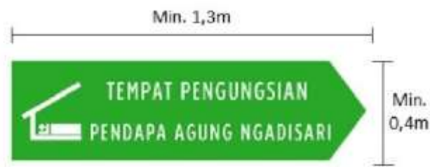
Gambar. Contoh Ilustrasi Panduan Visual Perancangan Rambu Bencana (contoh Rambu Petunjuk Bencana dengan Kata ukuran min 1,3 m x 0,4 m) di Track Wisata Alam/Tematik, Kawasan Taman Nasional Bromo-Tengger-Semeru, Provinsi Jawa Timur.
