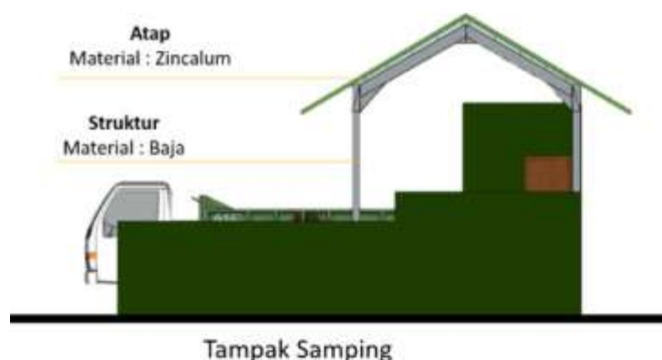
Gambar. Contoh Ilustrasi Panduan Visual TPS (Tempat Penampungan Sementara) Tipe I (ukuran kecil) di Kawasan Pariwisata
