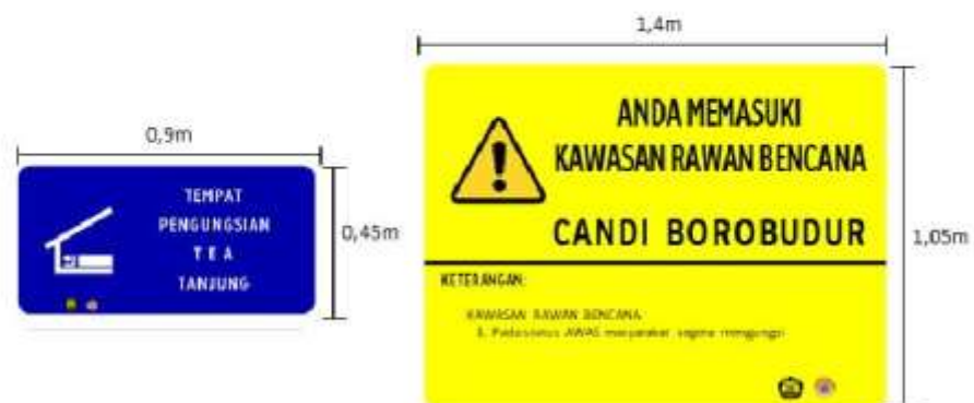
Gambar. Contoh Ilustrasi Panduan Visual Perancangan Papan Informasi Bencana (contoh papan informasi memasuki kawasan rawan bencana - kanan (ukuran 1,4m x 1,05 m) dan papan informasi penanda tempat lokasi pengungsian - kiri
