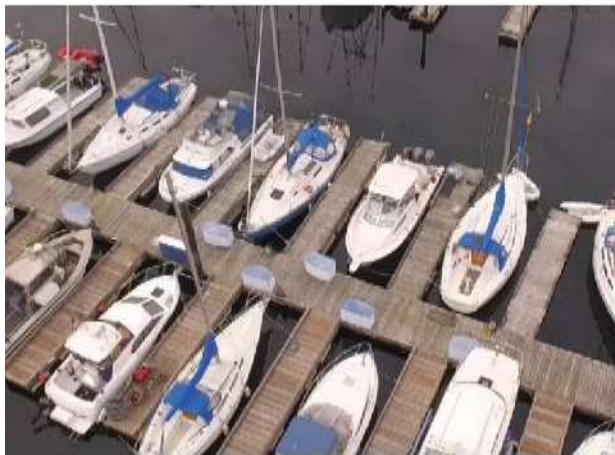
Gambar. Contoh Penerapan Titik Labuh/ Singgah Kapal Yacht yang mengkombinasikan Single Berth Configuration (kiri) dan Double Berth Configuration (kanan) (Lokasi: Nanaimo Yacht Club Dock, Kanada, Sumber:
