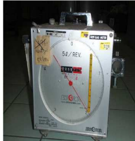
Wet Gas Meter
