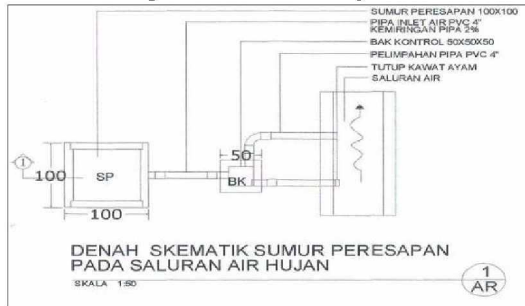
Gambar 4.3 Desain tutup dan buis beton sistem peresapan pada saluran air hujan
