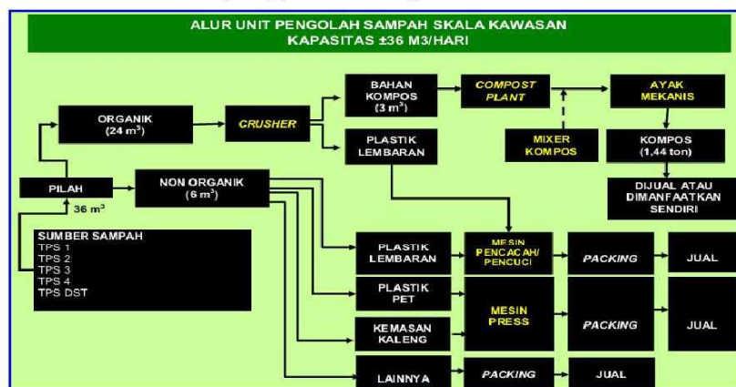
Alur unit pengolah sampah skala kawasan
