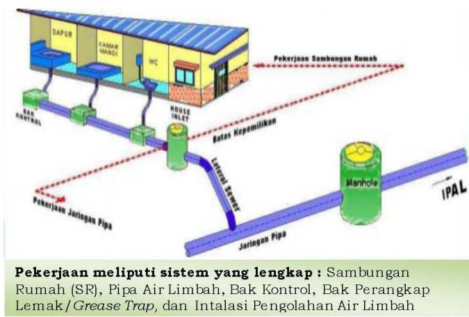
Gambar 1. Contoh Modul Jaringan Perpipaan Air Limbah Skala Komunal dan Prasarana Peleengkap
