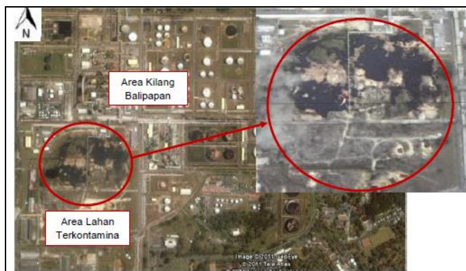
Gambar. 1 Sebaran Limbah B3 Berupa Acid sludge (Lahan Terkontaminasi Berada di Dalam Lingkaran Berwarna Merah)
