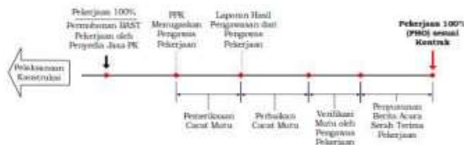
Gambar C.9. Tahapan Serah Terima Pertama Pekerjaan
