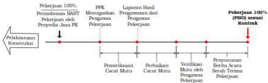
Gambar C.9. Tahapan Serah Terima Pertama Pekerjaan
