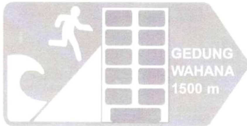
Gambar 7. Contoh rambu evakuasi lengkap dengan simbol, nama gedung dan jarak menuju ke tempat kumpul berupa bangunan
