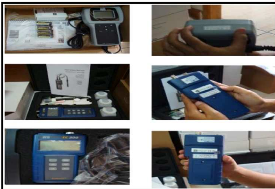
Gambar 1. Contoh alat bantu penyuluhan KP (DO Meter, pH Meter dan Salinity Meter)
