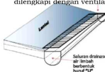
Gambar 18. Bentuk atap yang dilengkapi dengan ventilator roof
