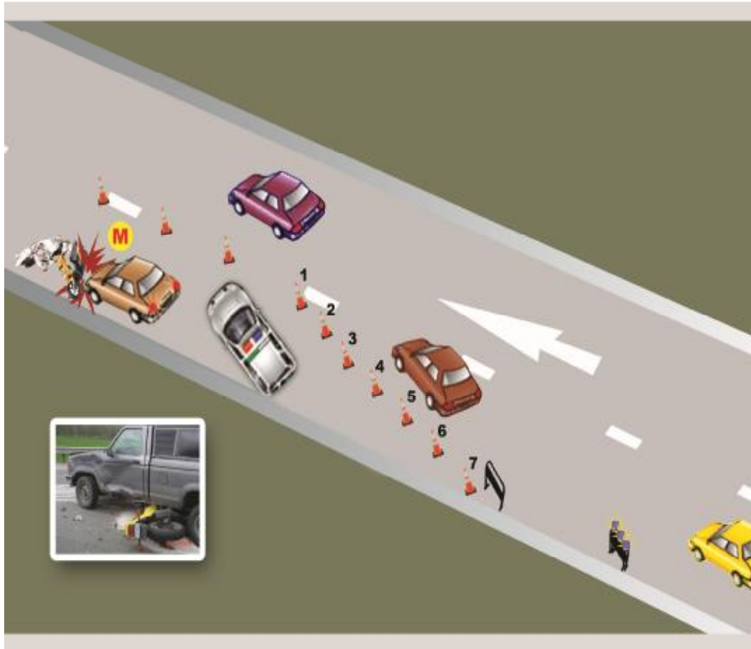
Gambar Tata Letak Alat Pengamanan TKP Untuk Jalur Jalan Satu Arah
