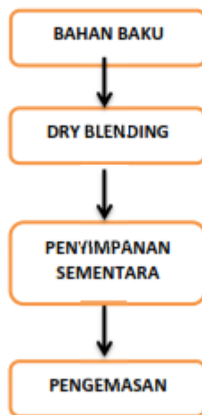
Gambar 3 – Bagan Alir Teknologi yang Hanya Menggunakan Dry Blending
