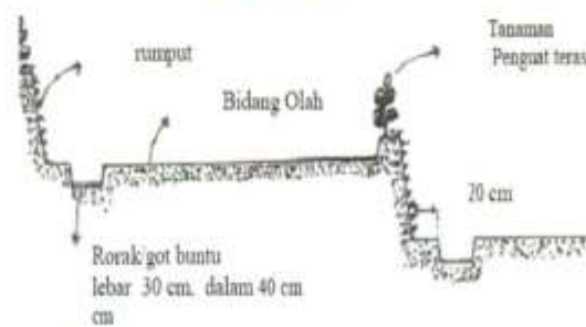
Gambar 4.96. Penampang melintang Rorak (saluran buntu)
