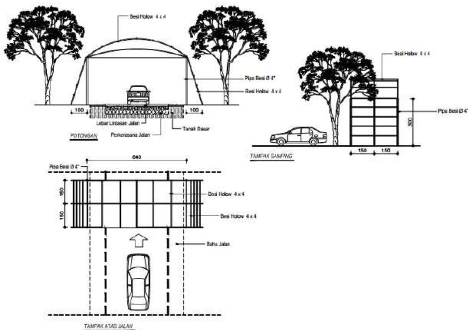
Jembatan kanopi dibuat dengan *Steel Frame*
